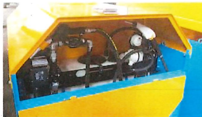
BT1750-1 / BT1000-2 mit zusätzlich 180 Liter Ad-Blue Tank und Abgabearmaturen
